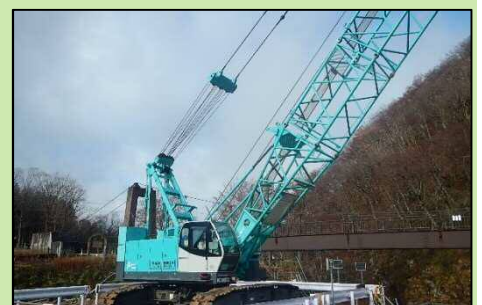
配置予定の70tクローラクレーン
