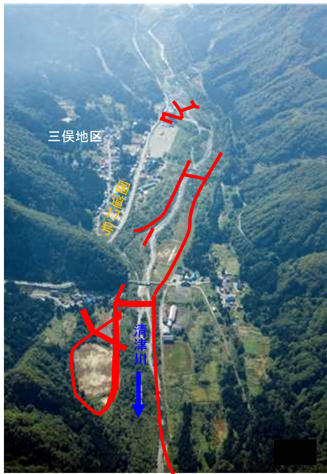
平成25年9月 台風18号による増水に伴う土砂移動で護岸が被災
