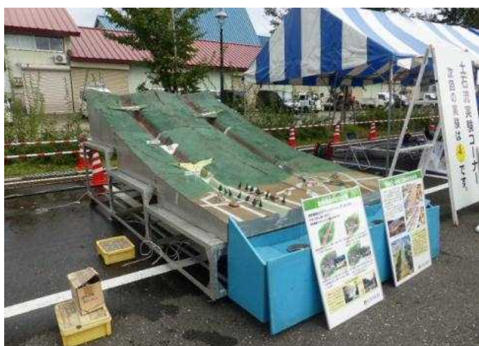
土石流模型実験装置全体像
