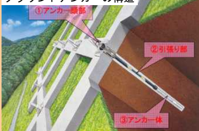
グラウンドアンカーの構造
