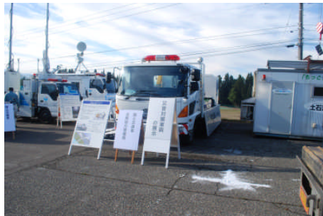
排水ポンプ車
