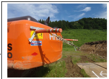
写真5 重機接触棒装置「エスカルバー」
