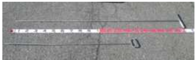
【写真2】 埋設物探索棒 1.4mと2m探索棒です。
