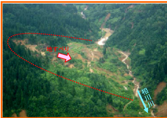
平成16年新潟県中越地震直後の小高地区上流の河道閉塞
