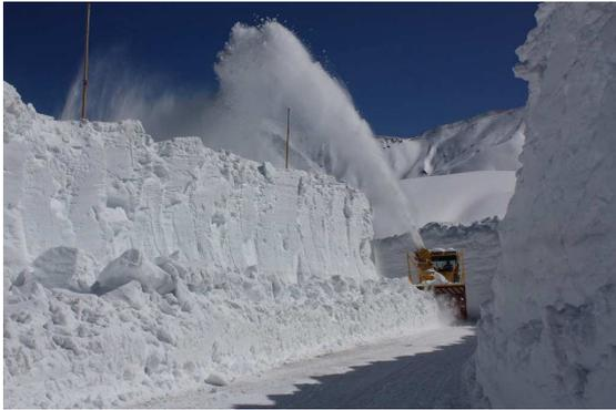
写真7 ③拡幅除雪（ロータリ除雪車）
