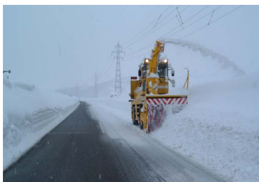
（写真-10）RTの路肩拡幅
