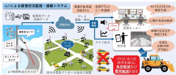
IoT機器で計測・撮影したデータをクラウド上で一元管理、一定の積雪量で自動通報
