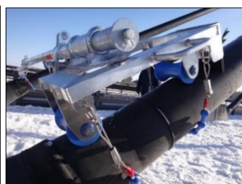
写真3 アルミ製スクレーパー
