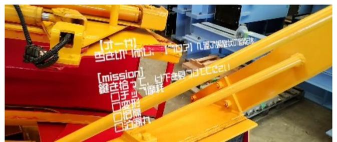
図 6.5 作業装置名と始業時点検項目の表示例
