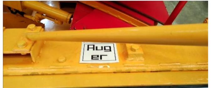
図 6.3 AR マーカをロータリ除雪車に貼り付けた例
