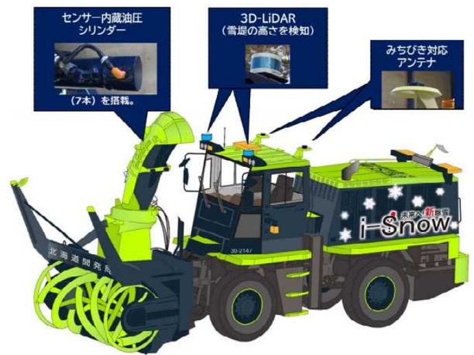
(図-6 自動化に関する設置機器)
