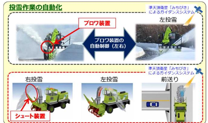
(図-4 ロータリ除雪車投雪作業の自動化)
