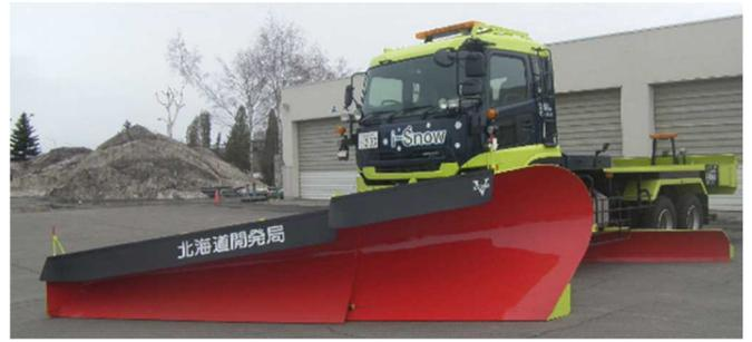
(写真-2 高規格道路用除雪トラック「4.5m」)
