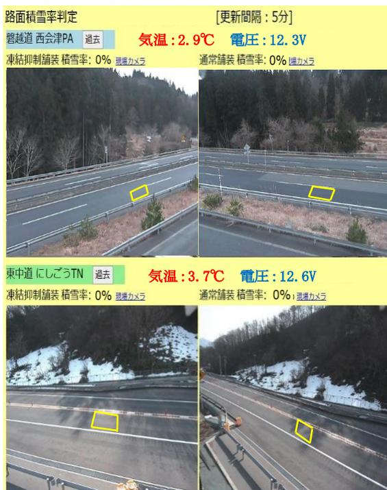
図3 凍結抑制舗装判定ソフトウェア
