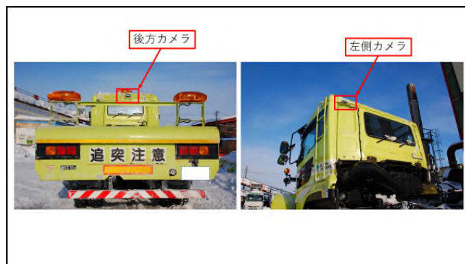
写真1. 除雪トラックカメラ装置
