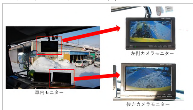
写真2. 除雪トラックカメラモニター
