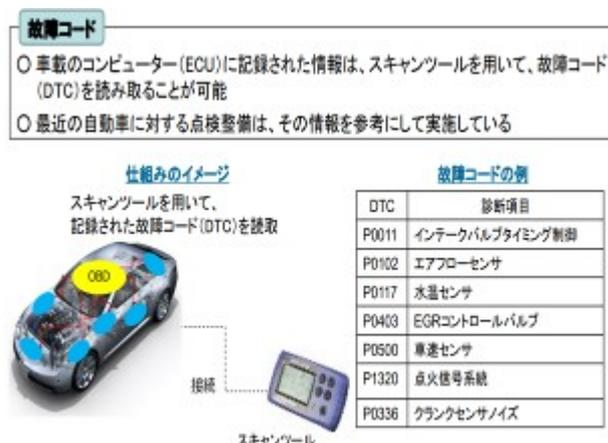
図1 外部診断機を用いた診断
