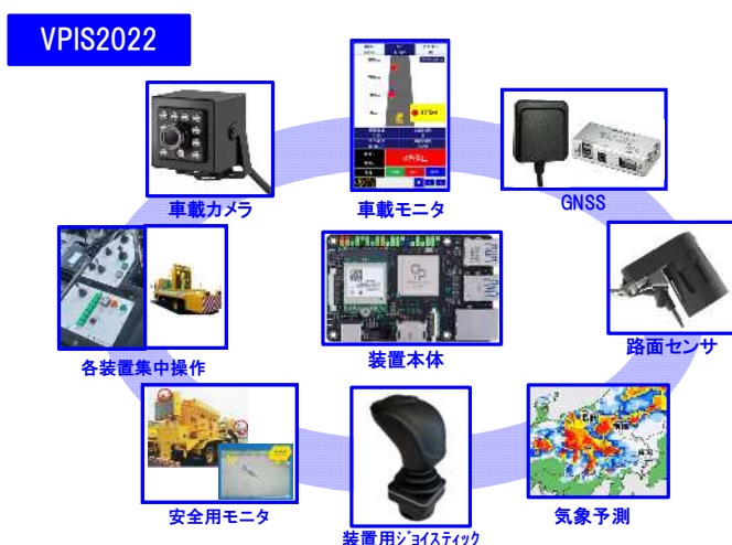
図1-車両位置情報システム（VPIS）の構成
