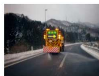
■凍結防止剤散布作業
