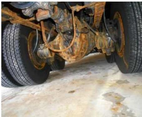
写真1\_雪氷車両の車両下部腐食状況①
