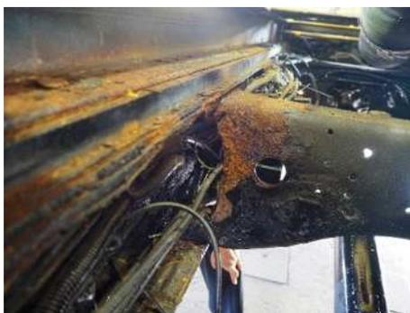
写真2\_雪氷車両の車両下部腐食状況②
