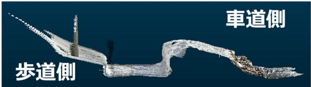
図 4 LiDAR による堆雪の点群 （上：鳥瞰図、下：道路横断方向への断面図）
