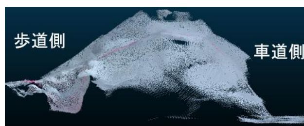
図 9 堆雪形状 A をセンシングした堆雪の点群 (上：登る、下：登らない)
