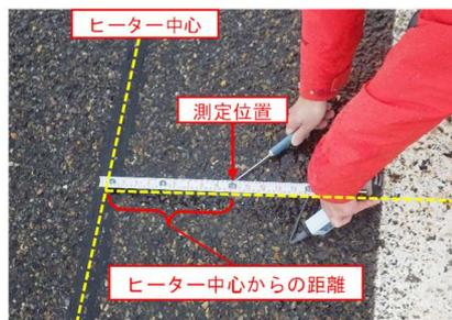
図10 路面温度 測定状況
