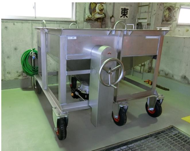
図 2-3 凍結防止剤適量積込装置
