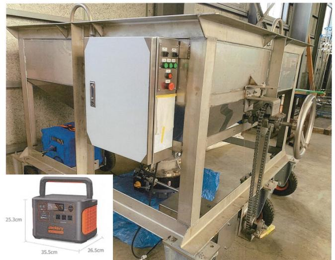
図4-3 凍結防止剤の適量積込装置電動化概要
