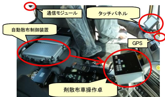
図 2-4 凍結防止剤自動散布システム
