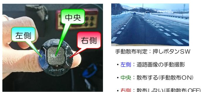
図 2-5 押しボタンSWによる手動散布判定
