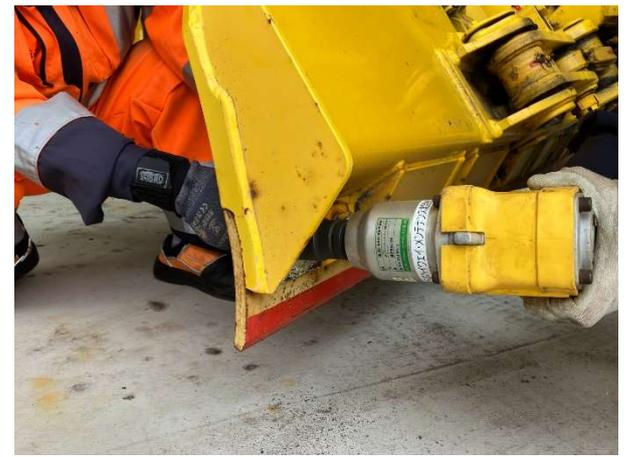
写真7 従来のプロボルト及びナット交換作業
