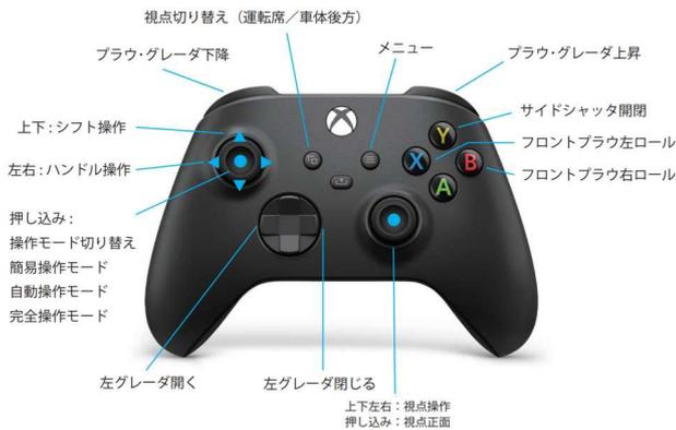
写真-2 シミュレータ用コントローラ
