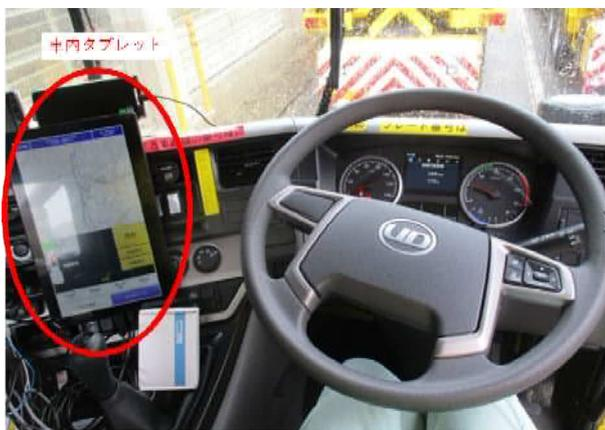
図3 車内タブレット設置状況
