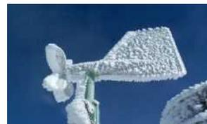
図11 雪で固着したプロペラ式の風向風速計
