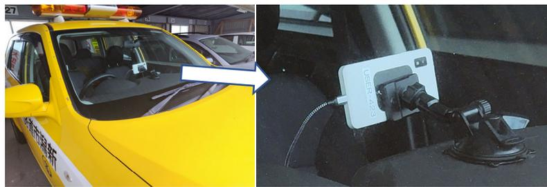
図1 パトロール車に取り付けられた AI スマホ路面判定装置(北区)
