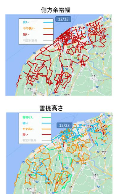
図4 側方余裕幅と雪堤高さ判定結果(2023.12.23)
