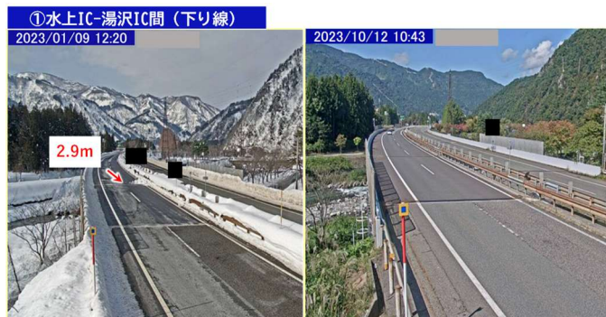
図-4 特に規模の大きな雪堤崩壊①
