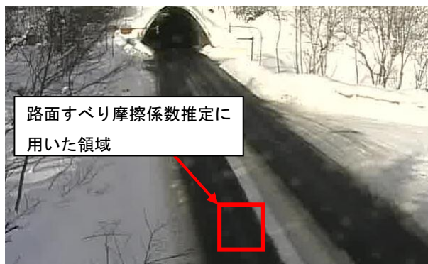
図5 非積雪路面における路面すべり摩擦係数の推定失敗例（路面すべり摩擦係数計測値：0.719、路面すべり摩擦係数推定値：0.281）
