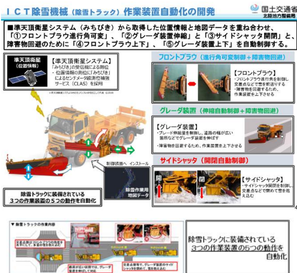
図14：ICT除雪機械作業装置自動化の開発
