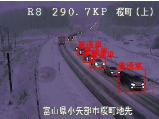
写真5：道路事象検知装置を搭載したカメラ映像
