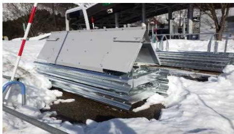
写真 5. 屋根付きのレーンオープナー
