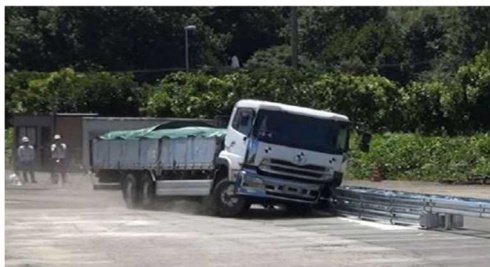
写真 6. 大型車衝突試験による性能確認
