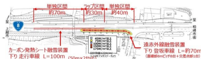
図4 消融雪装置の設置場所
