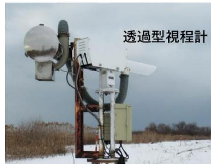
図 11 石狩吹雪実験場に設置された透過型視程計
