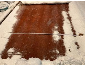
写真 15 23 時【0～3・10】 融雪幅 180 cm 最大降雪時【3.5 cm/時間】
