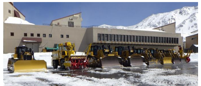
写真2 立山有料道路で働く除雪機械
