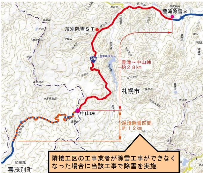
図 3 隣接工区越境除雪区間図
