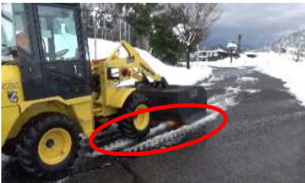
写真4 路面乾燥車実働状況②
