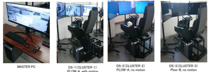
図-12 管理用PCと運転模擬用PC(3台)
