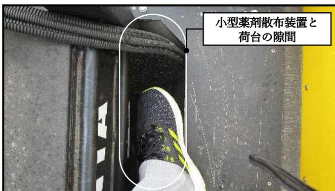
図 11 小型薬剤散布装置と荷台の隙間
