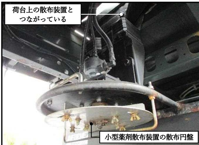
図 10 小型薬剤散布装置の散布円盤
