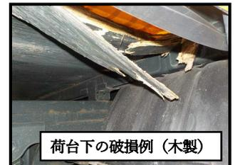
図 8 荷台下の破損例
