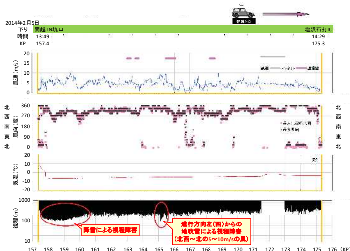
図4 移動気象観測結果例（関越TN坑口～塩沢石打IC間）
