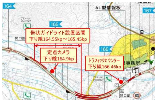
図5 帯状ガイドライト設置区間及び機器配置位置
