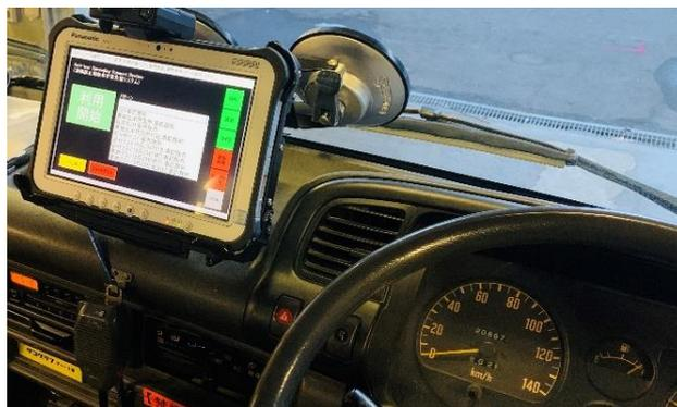
図2 運転席付近に設置した車載タブレットPC
