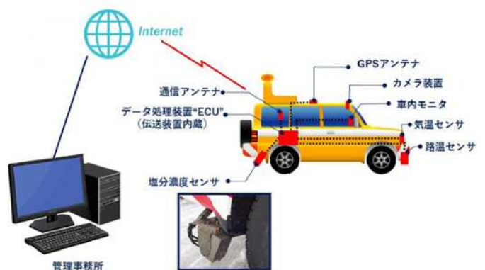
図6 車載式残留塩分濃度測定システム [2]
