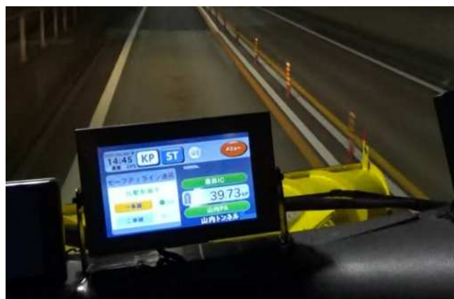
写真10 GPS端末での運用（車内状況）
