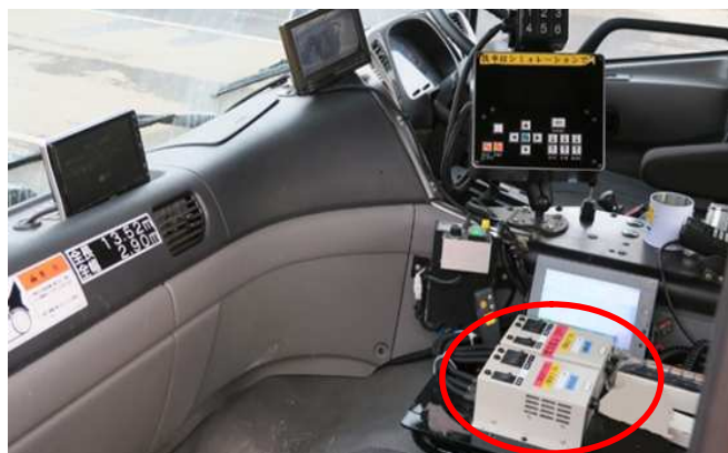
写真9 2灯式の手動切替装置
