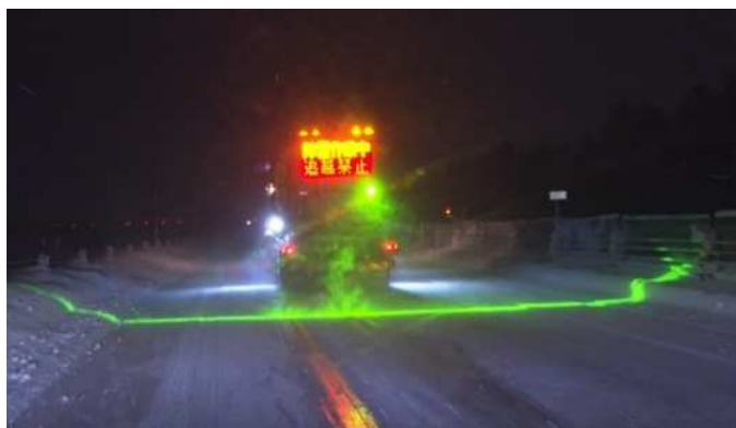
写真５ セーフティライン 路面標示状況
