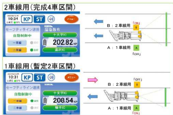
図4 GPS車載端末装置を利用した運用図
