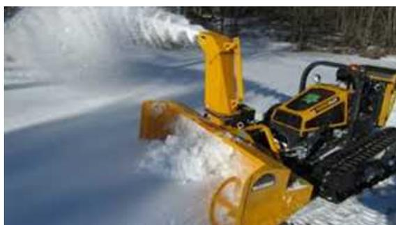
(写真1 2) 遠隔式ロータリー除雪車の例
