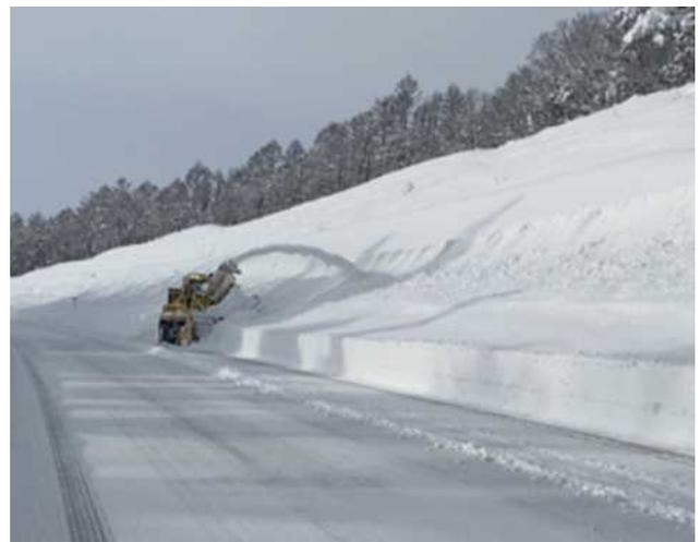
(写真9) ロータリー除雪車による本線除雪
