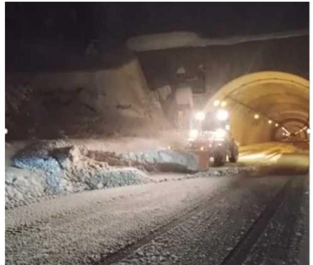
(写真8) トラクターショベルでの本線逆走除雪
