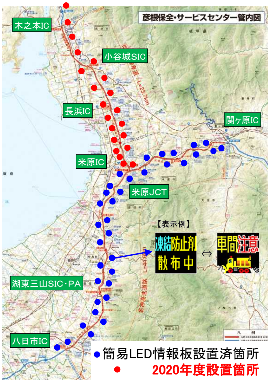
図6 彦根管内簡易LED情報板設置状況
