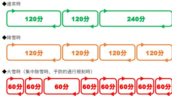
図-6 除雪機械編成（国道7号）と除雪時間
