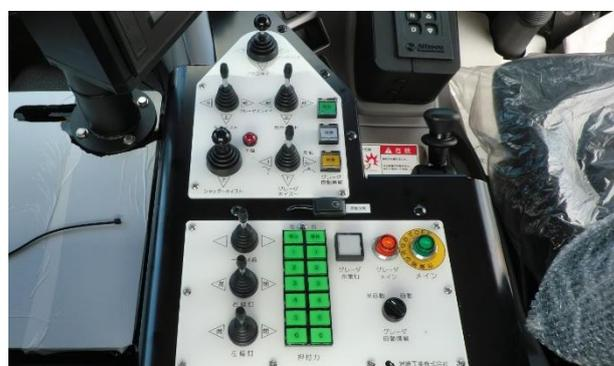
写真-1 除雪トラック作業装置操作パネル
