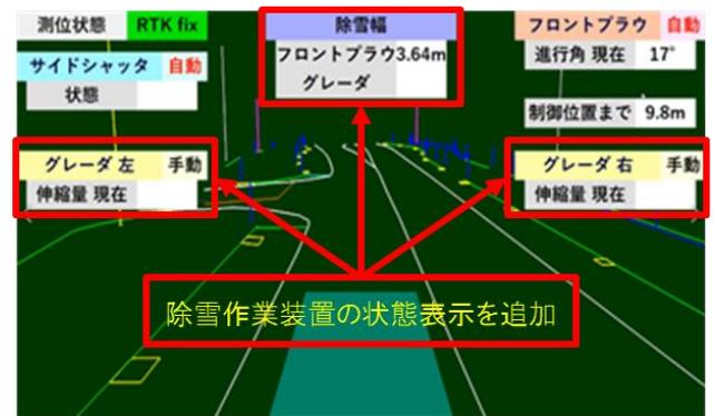
図-6 自動操作制御装置の表示画面例
