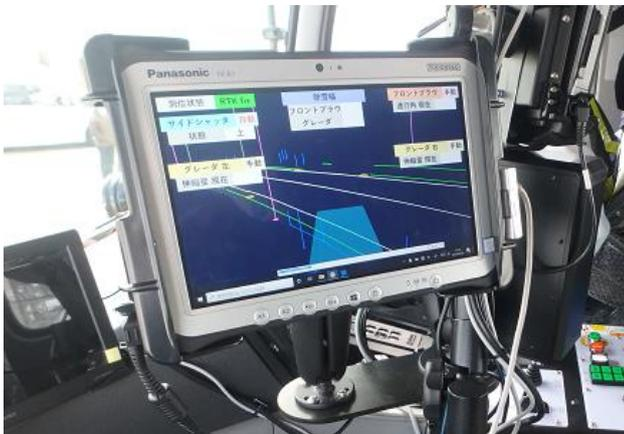
写真-2 自動操作制御装置
