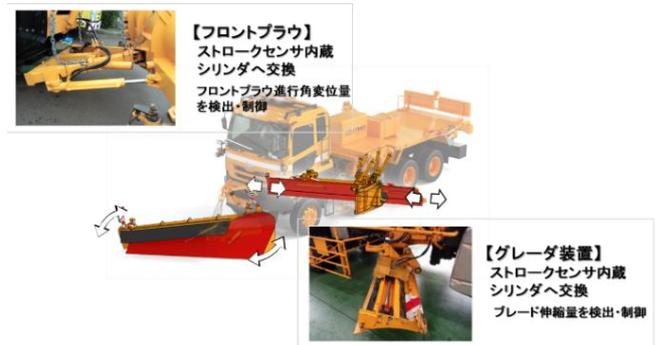
図-5 除雪トラック試験機改良箇所
