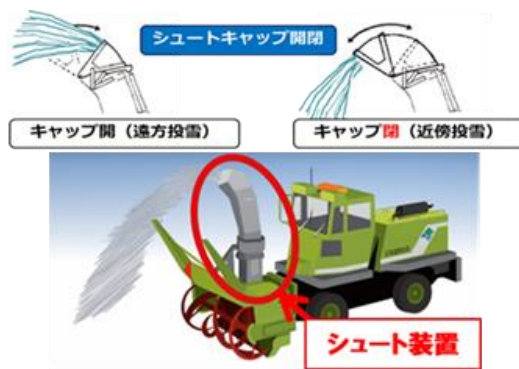
図-6 シュート装置及びシュートキャップの開閉
