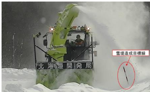
写真-4 雪堤高さ検知シュート制御試験
