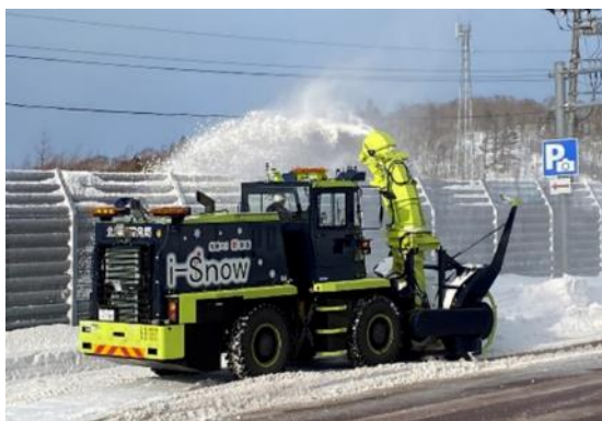
写真-2 道路附属物等の障害物を避けた投雪作業
