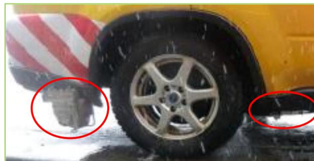
写真9 塩分濃度センサと散水ノズル
