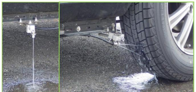
写真10 ノズルの最終仕様と水噴射の様子
