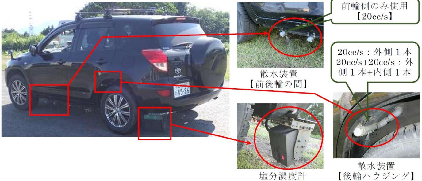
写真7 試験コースでの測定に使用した測定車
