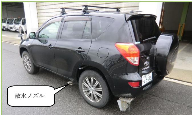
写真4 乾燥路面測定ユニット装着車
