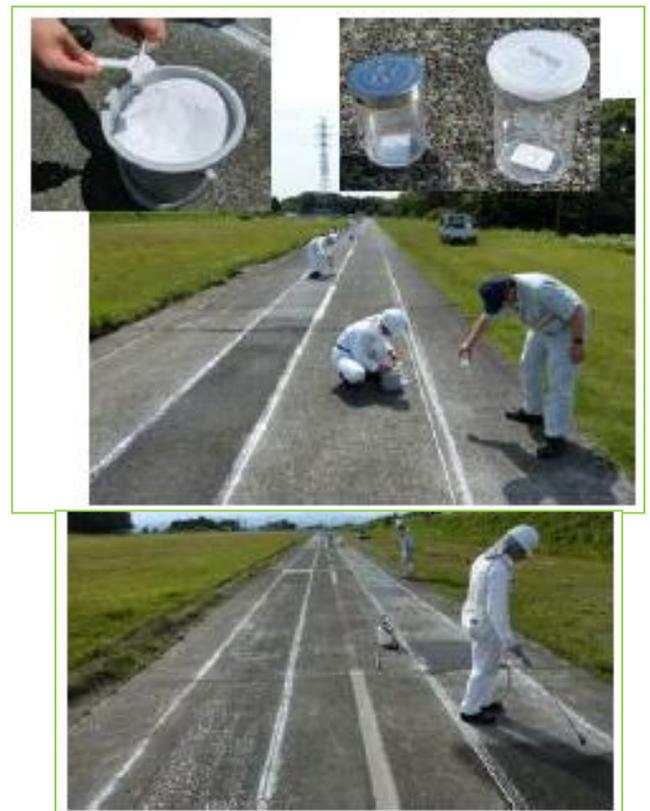
写真6 試験コース作成の様子
