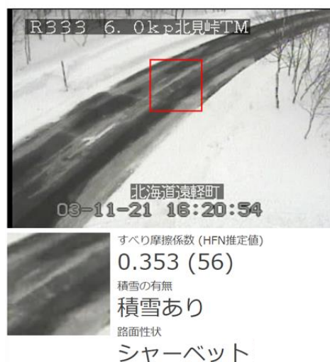
図6 道路CCTVカメラ画像を用いた路面すべり推定システム
