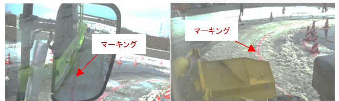
写真5 マーキング試験の除雪走行状況
