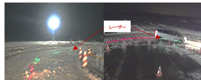
写真 9 レーザー照射試験の乗用車走行状況（エプロン走行）
