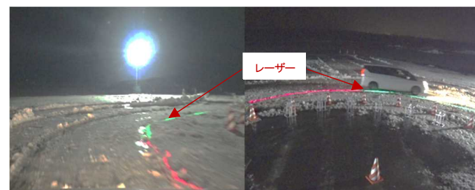
写真 8 レーザー照射試験の乗用車走行状況（環道走行）
