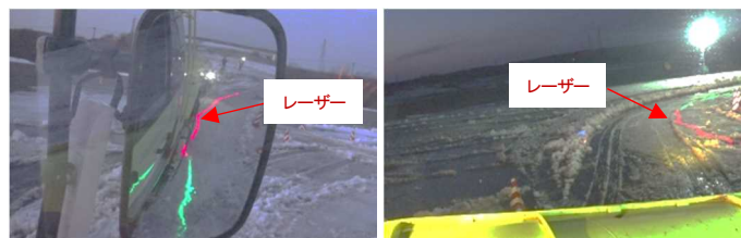
写真 6 レーザー照射試験の除雪走行状況
